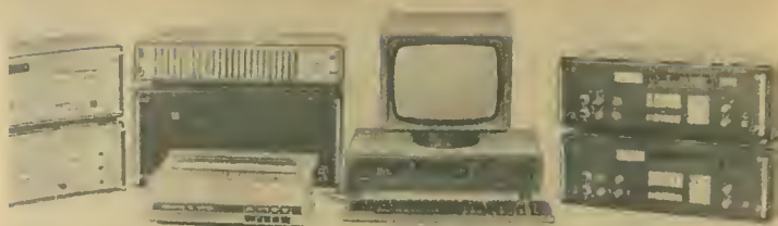
Bild 3 CINRAS heißt die Anwenderlösung für den Aufbau eines automatisierten Kurzwellenfunksystems. Herzstück des Systems ist die Steuereinheit KCP 1710 (Foto: RFT-Pressedienst)
