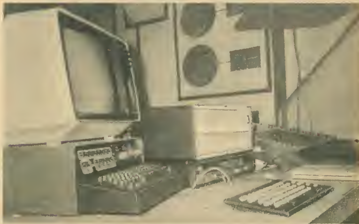
Bild 8 Der FFT-88: Zusammengeschaltet mit einem KC-85/3, einer Flachtastatur, einem Fernsehgerät Junost, einem Farbfernsehgerät sowie wahlweise mit 24 Fernschreibmaschinen F 1200 oder 24 Marsegebern 80 (Foto: K. König)
