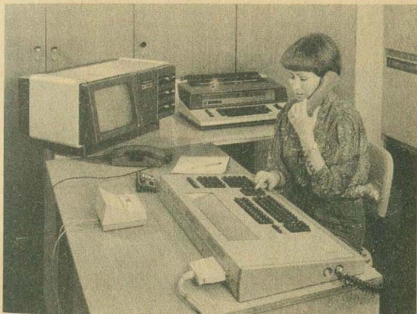
*Bild 1 Die digitale Nebenstellenzentrale NZ 400 D/384 ist datenfähig. Sie ermöglicht einen Anschluß an ein Datennetz über die X25-Schnittstelle (Foto: RFT-Pressediens)*
