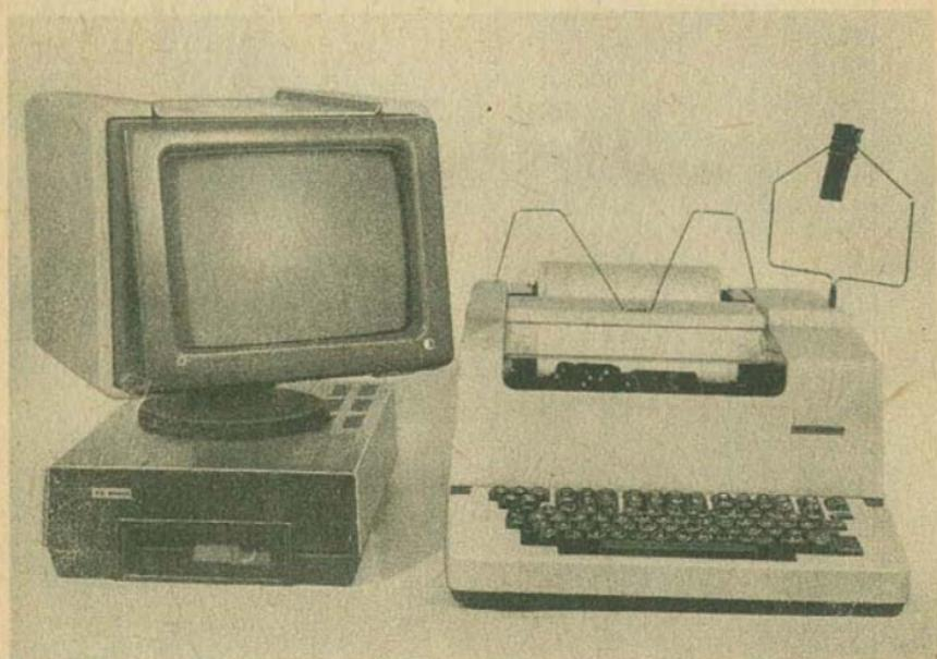
Bild 2 Der elektronische Fernschreiber F2000, mit der Textverarbeitungseinheit TE 2000 zu einem Bürokommunikationszentrum erweitert (Foto: RFT-Pressedienst)
