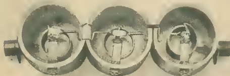
Bild 8 Aufbauvorschlag für ein 3-Kreis-Wendeltopfkreisfilter mit rundem Außenleiter (a), Seitenansicht des Filters nach Bild 8 (b)
