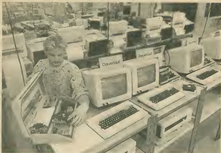
Bild 2 Der Arbeitsplatz-Computer A7100 ist ein 16-bit-Rechner, der in der DDR in hohen Stückzahlen im VEB Kombinat Robotron hergestellt wird (Foto: Brüggmann)
