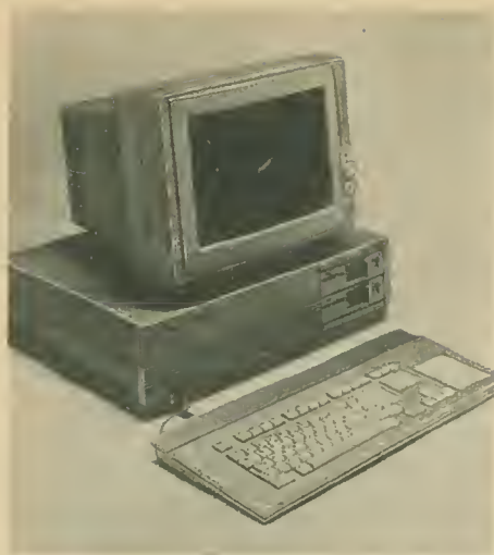
Bild 2 Der neue 16-bit-Personal- computer EC 1834 von Ro- botron ist das Standardgerät einer neuen Entwicklungslini- e hochleistungsfähiger Ar- beitsplatztechnik (Foto: RFT-Pressedienst)
