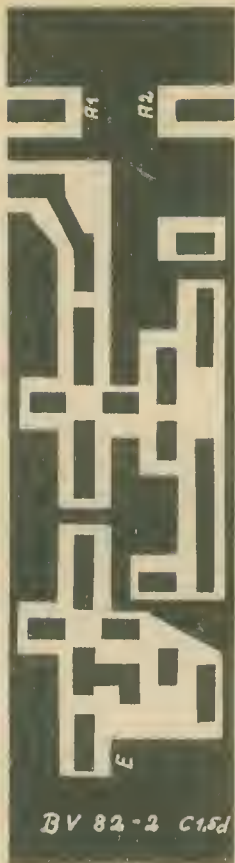
Bild 3 Leiterplattenentwurf für einen Breitbandverstärker nach Bild 2; Material: Cevaunit doppelkaschier, Rückseite glatt als Massefläche, 115 mm × 30 mm
