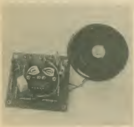
Bild 19 Die Musterleiterplatte mit angeschlossener Hörkapsel
