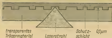
Bild 5 Aufbauprinzip der CD- Platte
