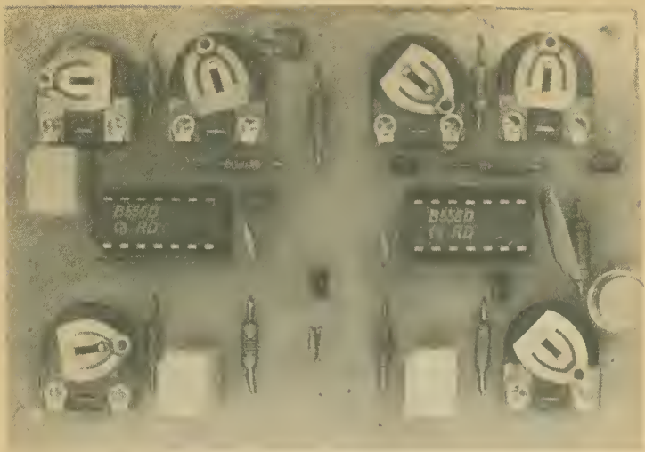
Bild 15 Ansicht des fertigen Musteraufbaus des 3-Ton-Generators
