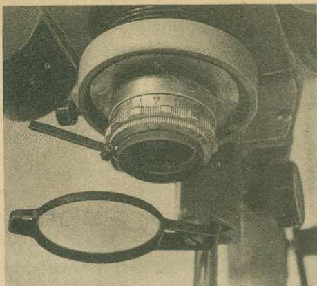
Bild 5 Ansicht des Blendenstellhebels und der Streuscheibe am Vergrößerungsgerät
