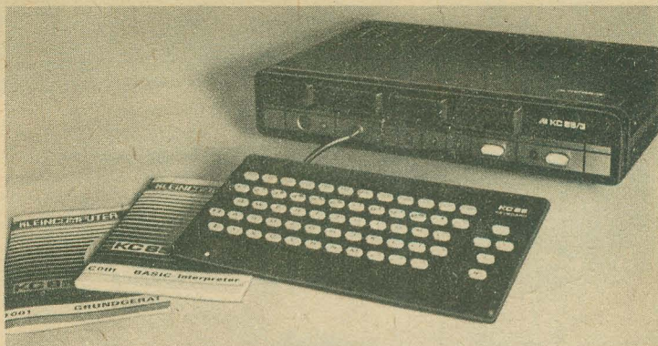
Bild 5 Der neue Kleincomputer «KC 85/3» mit eingebautem ROM-BASIC-Interpreter ist vielseitig einsetzbar (Foto: RFT-Pressedienst)
