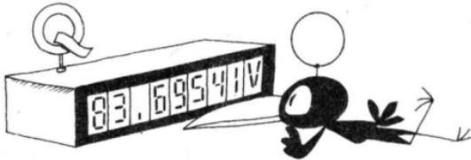
Das digital anzeigende Ohmmeter kann Widerstandswerte im Bereich von etwa  $100 \Omega$  bis  $999 \text{ k}\Omega$  genau erfassen und wählt den günstigsten Anzeigebereich selbst. Die Signalisierung des Bereichs geschieht durch Umschalten des Dezimalpunkts:
