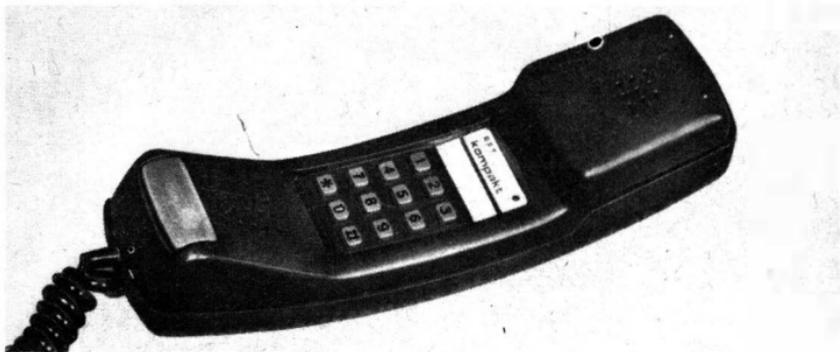
*Bild 6 Der Fernsprechapparat Kompakt hat alle Funktionen elektronisch im Handapparat realisiert und kann als Fernsprechendgerät überall eingesetzt werden (VEB Kombinat Nachrichtenelektronik) (Foto: RFT-Pressedienst)*
