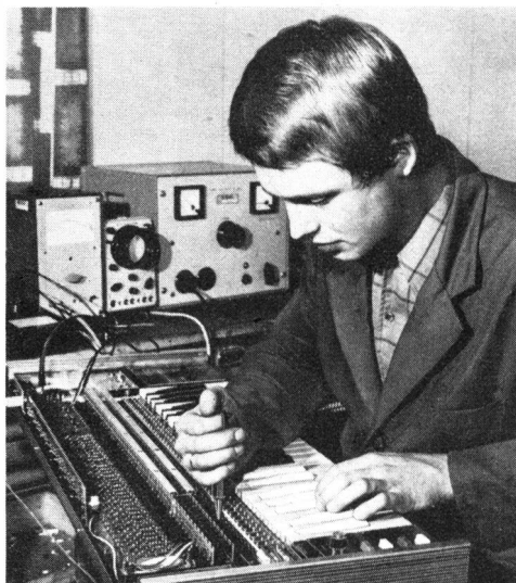
Bild 3 Während der Endprüfung werden die Tastenkon- takte sorgfältig justiert (Foto: Pressestelle VER- MONA)
