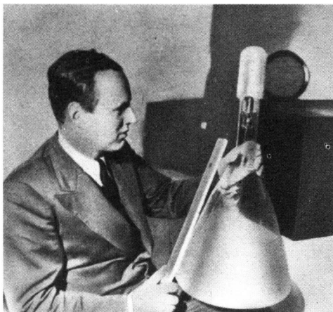
Bild 4 Manfred von Ardenne mit einer von ihm entwickel- ten Fernsehbildröhre 1934
