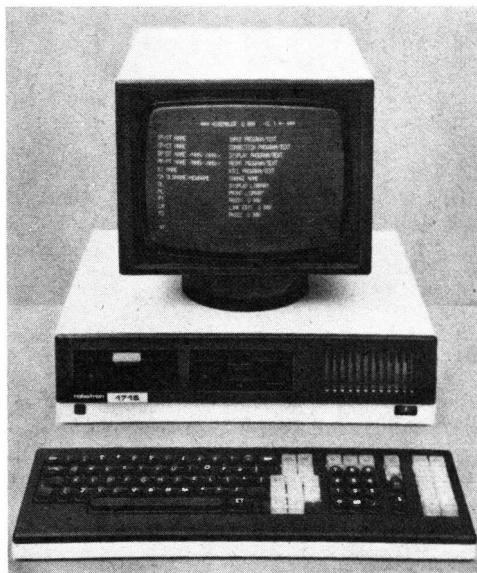
Bild 4 Der Personalcomputer robotron PC 1715 ist mit einem 64-kByte-Speicher ausgerüstet, er kann mit bis zu 4 Diskettenlaufwerken ergänzt werden (Foto: RFT-Pressedienst)
