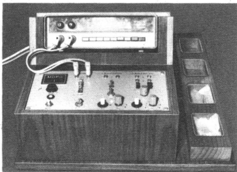
Bild 1 Prüfgerät zum Ausmessen von Feldeffekttransistoren und zum Prüfen beheizter Dioden
