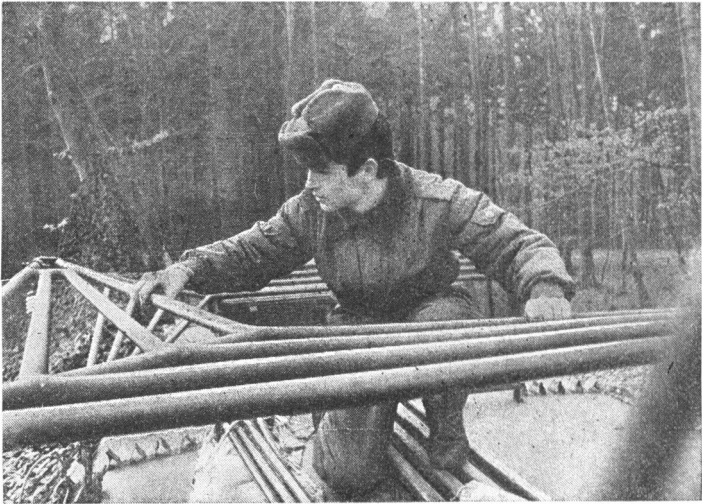
Bild 5 Mit wenigen Handgriffen ist die Rahmenantenne auf dem Dach des SIL-121 sendebereit. Neben ihr können auch Dipol-, Flach-, Stab- und V-Antennen betrieben werden
