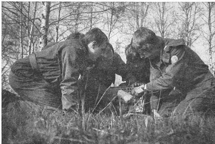
Bild 3 Die Fernsprechvermittlung OB 62/10 ist eine schnurlose Verbindung, die in der vormilitärischen Laufbahnausbildung Nachrichtenspezialist auch eingesetzt wird als Funkvermittlung. Hier erläutert Bernhard Wiezorek, Y31 YF (zweiter von links), die Bedienungsweise des Geräts
