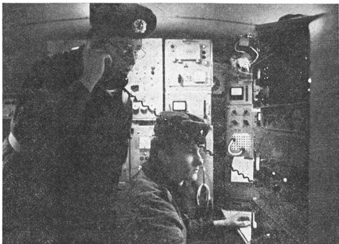
Bild 2 Senderaum einer Station mittlerer Leistung im Basisfahrzeug SIL-121. Funkzugführer Leutnant Thorentz prüft die geschalteten Dienstverbindungen und Kanäle
