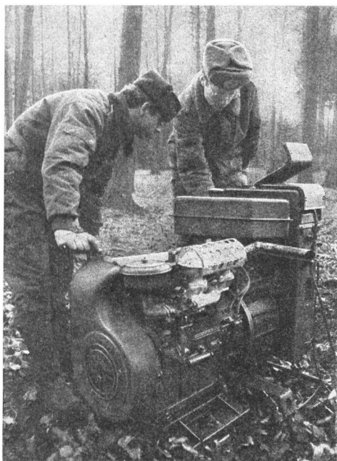
Bild 8 Anschluß und Inbetriebnahme des AB-4 – sowjetisches Stromaggregat «Aggregata Benzina» mit 4 kW Leistung
