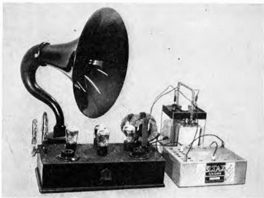
*Bild 10 Eine komplette Empfangsanlage um 1927: Empfänger (Radio-Amator, Typ 3044) mit Trichterlautsprecher (Telefunken), Heizakkumulator und Anodenbatterie*
