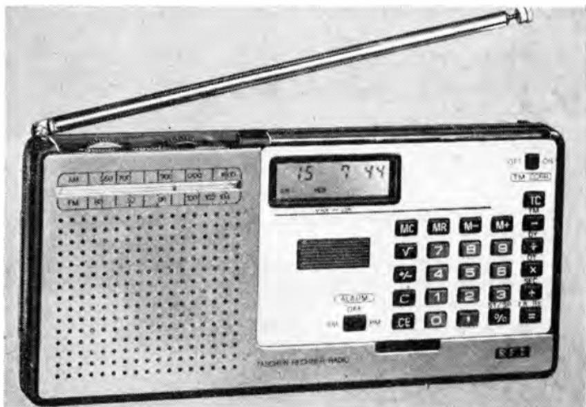
*Bild 4 Aus den Bestandteilen AM/FM-Radio, Quarzuhr und Taschenrechner besteht das Taschenrechnerradio TR 81. Das Uhrenteil kann auch als Stoppuhr und als Wecker verwendet werden. Die Abmessungen sind 161 mm × 76 mm × 21 mm – VEB Halbleiterwerk Frankfurt (Oder)*
