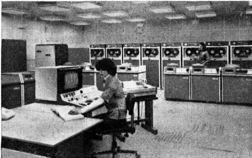
*Bild 11 Das elektronische Datenverarbeitungssystem EC 1055/1055 M erschließt mit seinem modernen Systemkonzept erweiterte Einsatzmöglichkeiten (VEB Kombinat ROBOTRON)*
