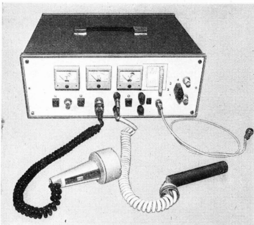
Bild 7 Prüfgerät für *UFT 422*
