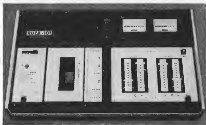
Bild 4 Das Spitzengerät unter den Stereokassettenbandgeräten ist Ruta-101-Stereo mit einem eingebauten Stereo-NF-Verstärker (2 × 10 W Musikleistung) und einer Geräuschminderungsschaltung
