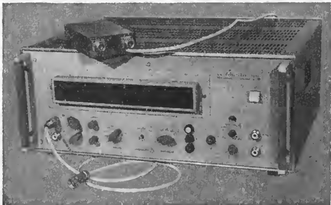
Bild 3 Gerät zur Messung von Laufschwankungen an Schußwaffen
