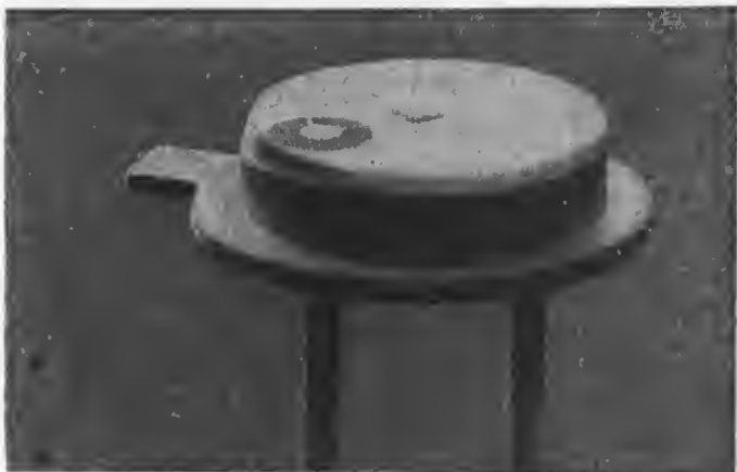
Bild 6 Die Infrarotemittierende Diode FV 21 IR (Siemens) hat einen planen Epoxidharzverschluß über dem lichtemittierenden GaAs-Chip, so daß die Glasfasern eines Lichtwellenleiterkabels direkt angesetzt werden können. Das Gehäuse hat einen Durchmesser von 5,4 mm und eine Höhe von 1,3 mm. Bei 100 mA beträgt die Strahlungsleistung 1 bis 2 mW, die Wellenlänge ist 880 nm
