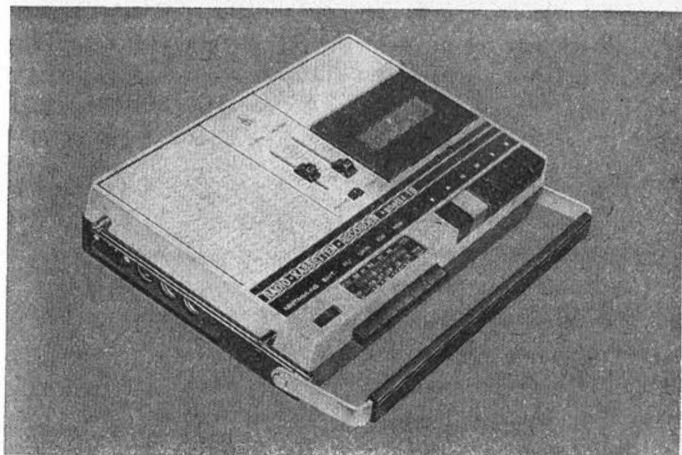
Bild 4 In der neuen Version wurde der NF-Verstärker des Radiorecorders Anett IS mit einer integrierten Schaltung bestückt, die Ausgangsleistung ist 700 mW
