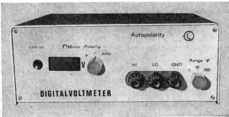
Bild 4 Ansicht des einfachen Digitalvoltmeters
