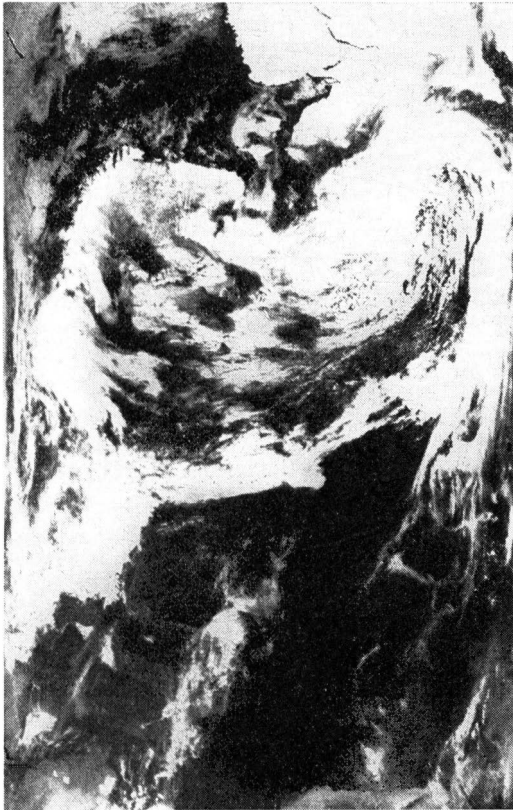
Bild 2 Wolkenbild im sichtbaren Spektralbereich vom 8. 5. 73, aufgenommen als APT-Bild mit der WES-2 (gedehnte Aufzeichnung mit 96 U/min des Abstradiometers)
