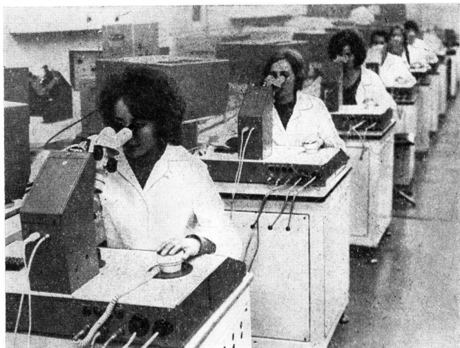
Bild 2 Die hauchdünnen Drahtverbindungen zwischen dem Chip des MOS-Schaltkreises und den einzelnen Anschlüssen werden im Kombinat VEB Funkwerk Erfurt mit dem Ultraschall-Bonder hergestellt
