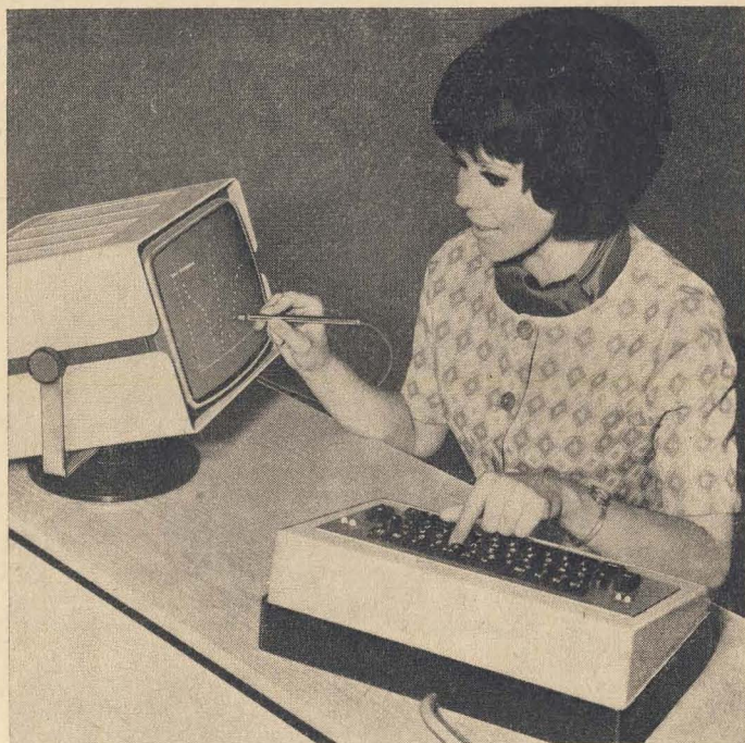
Bild 7 Das Bildschirmsystem dient der unmittelbaren Kommunikation zwischen Mensch und EDVA, es ermöglicht die Anzeige, Ein- und Ausgabe alphanumerischer Zeichen
