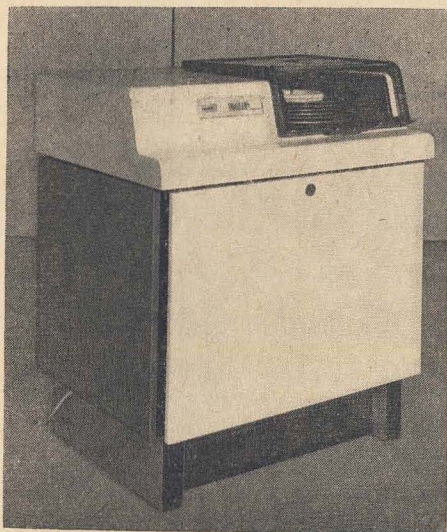
Bild 4 Der Wechseltatenspeicher ist ein universell einsetz- barer Speicher mit wahl- freiem Zugriff und einer Speicherkapazität von 7,25 Mio. Byte je Plattenstapel
