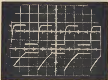
Bild 16 Oszillogramme zu Bild 15; oben: Impulse am Punkt 1 des IS, unten: Impulse am Punkt 6 des IS, Maßstab y-Achse: 2,5 V/cm
