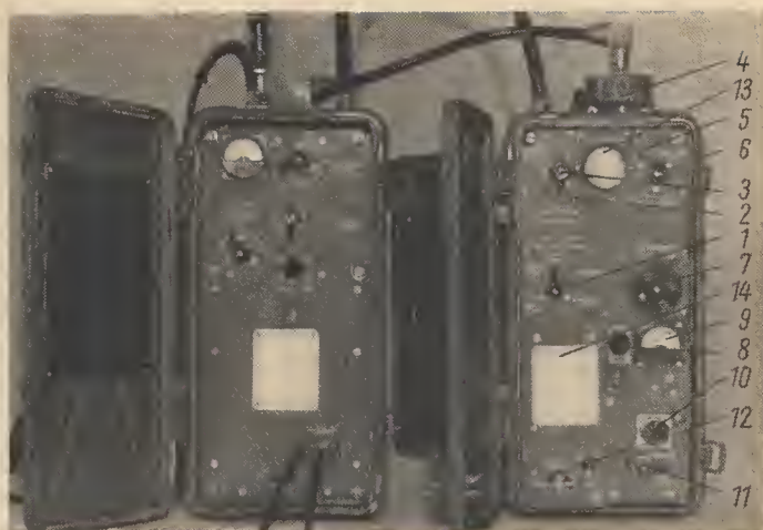
Bild 2 Gehäusedraufsicht des Funkgeräts R-105-D; 1 — Antennenanschluß, 2 — Tragegriff, 3 — Ösen für Tragriemen, 4 — Buchse für Handlampe, 5 — Anschluß für Sprechgarnitur oder Handapparat, 6 — Klemme für Doppelleitung, 7 — Klemme für Doppelleitung oder Gegengewicht
