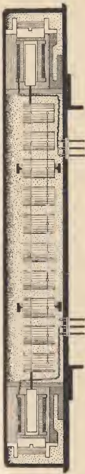
Bild 1 Elektromechanisches Torsionsfilter (Prinzip) für 200 kHz Bandmittelfrequenz
