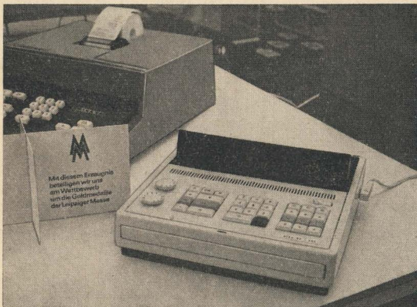
*Bild 3 Der elektronische Tischrechner ELKA 42 LSI stellt ein Spitzenerzeugnis der bulgarischen Elektronikindustrie dar. Aufgebaut ist der Tischrechner mit integrierten Schaltkreisen. Der Berliner Kooperationspartner des bulgarischen Werkes ist der VEB Werk für Fernsehelektronik, der die Ziffern- und Zeichenanzeigeröhren produziert*
