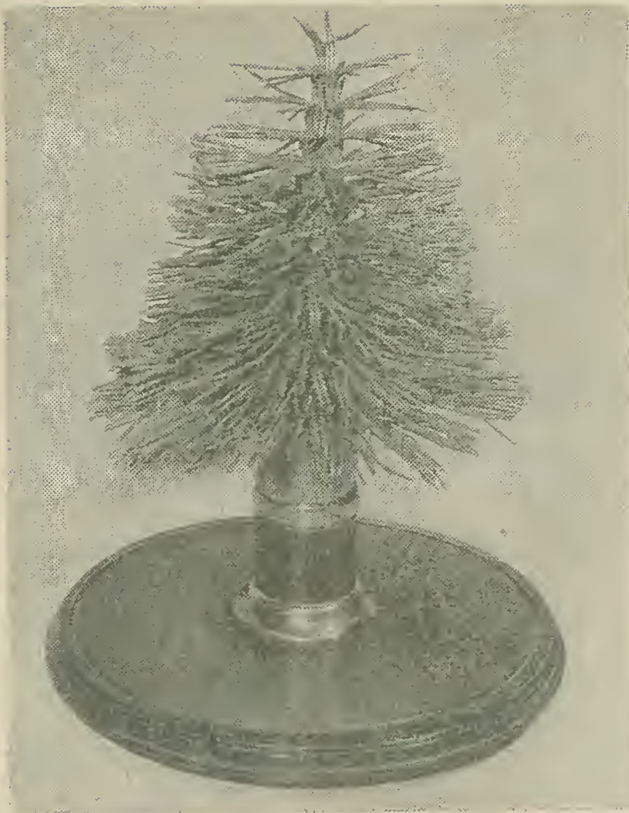
Bild 1 Ortskabel aus der Zeit um 1900 mit 300 Leitungspaaren
