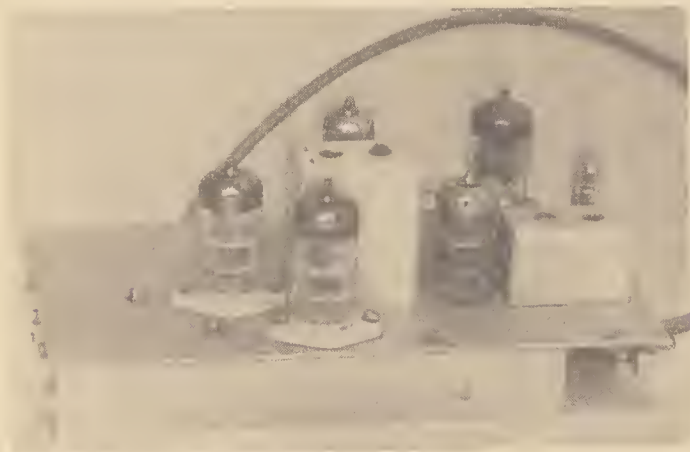
Bild 5b Ansicht des 70-cm-Konverters (von unten) (beide Fotos zeigen den Konverter mit nur 3stufigem Oszillator, Quarz = 44,888 MHz)
