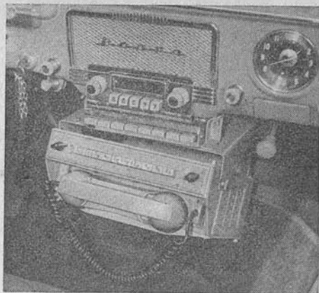
Bild 3 Vorwiegend mit Transistoren bestückt ist das Funkgerät Altai. Je Fahrzeugstation stehen 8 Sprechkanäle für den Ortsverkehr und 2 Sprechkanäle für den Linienverkehr zur Verfügung
