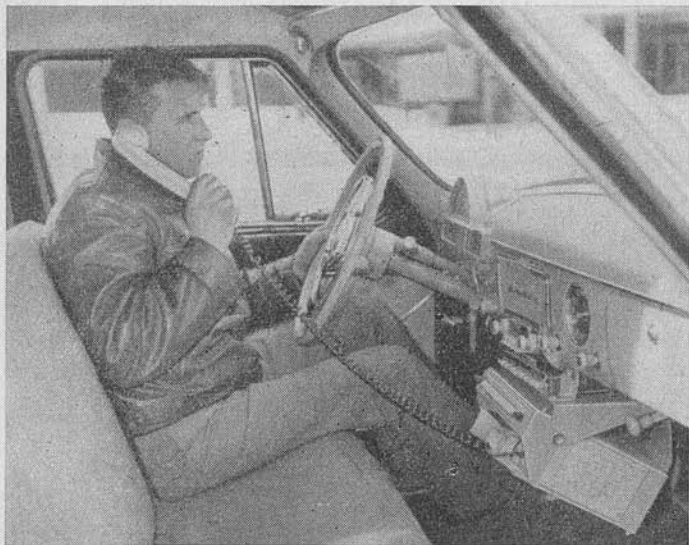
Bild 2 Das Funkgerät Altai wird unter dem Armaturenbrett des Wolga angebracht. Schnell und einfach kann es der Fahrer bedienen
