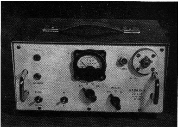
Bild 4 Ansicht des beschriebenen Fuchsjagdsenders 3,5/144 MHz
