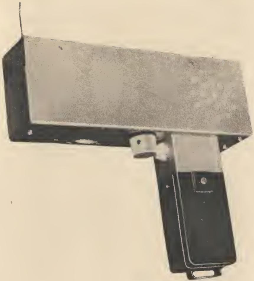
*Beliebt bei den Nachrichtensportlern der GST ist die Fuchsjagd. Dabei wird ein im Gelände versteckter Sender mit Peilempfängern gesucht. Für die Fuchsjagd im 80-m-Amateurband konstruierte der Funkamateurl G. Pietsch, DM 2 AVL, diesen handlichen Fuchsjagdpeilempfänger. Im Griff befindet sich die Batterie zur Stromversorgung. Der obere Teil des Geräts enthält einen vollständigen Transistorsuper mit Lautsprecher und Ferritantenne*
