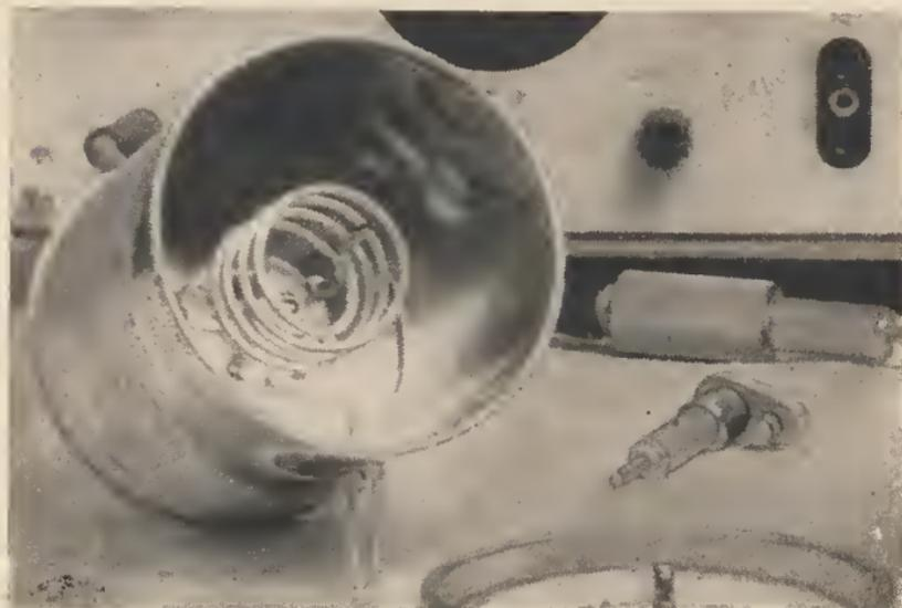
*Bild 4 Einfacher Absorptionskreis von 100 MHz bis 150 MHz*
