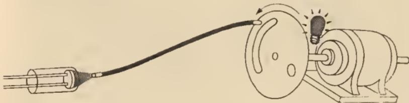
Bild 3 Faseroptik als Übertragungsleitung für moduliertes Licht
