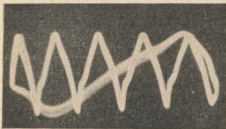
Bild 3 Ausgangssignal des TS-7, mit einem NF- Oszillografen sichtbar ge- macht (der NF-Schwin- gungszug ist gut zu erken- nen)
