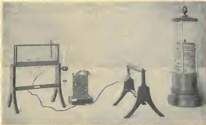
Bild 7 Der elektrolytische Telegraph von Sömmerring. Links der Empfänger, rechts der Sender und die Stromquelle
