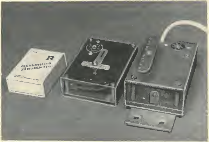
Bild 1 Zwei vom Verfasser konstruierte Rudermaschinen im Vergleich zu einer Streichholzschachtel
