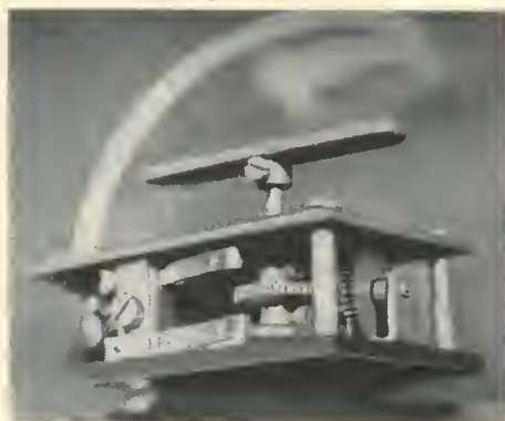
Bild 9 Ansicht der fertigen Rudermaschine, noch ohne Abdeckung
