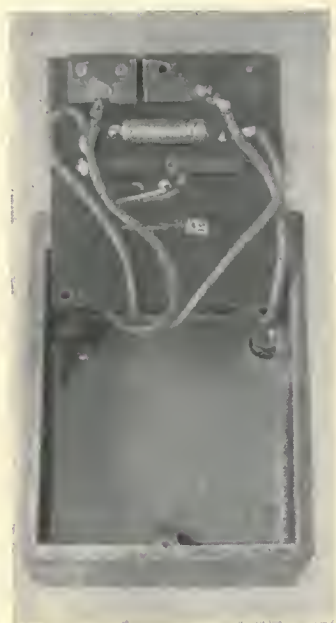
Bild 6 Blick in die Verdrahtung des Sprechgerätes
