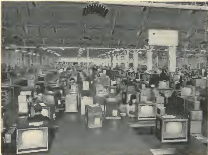
Bild 1 Blick auf die Endkontrolle in der Fertigung moderner Fernsehgeräte
