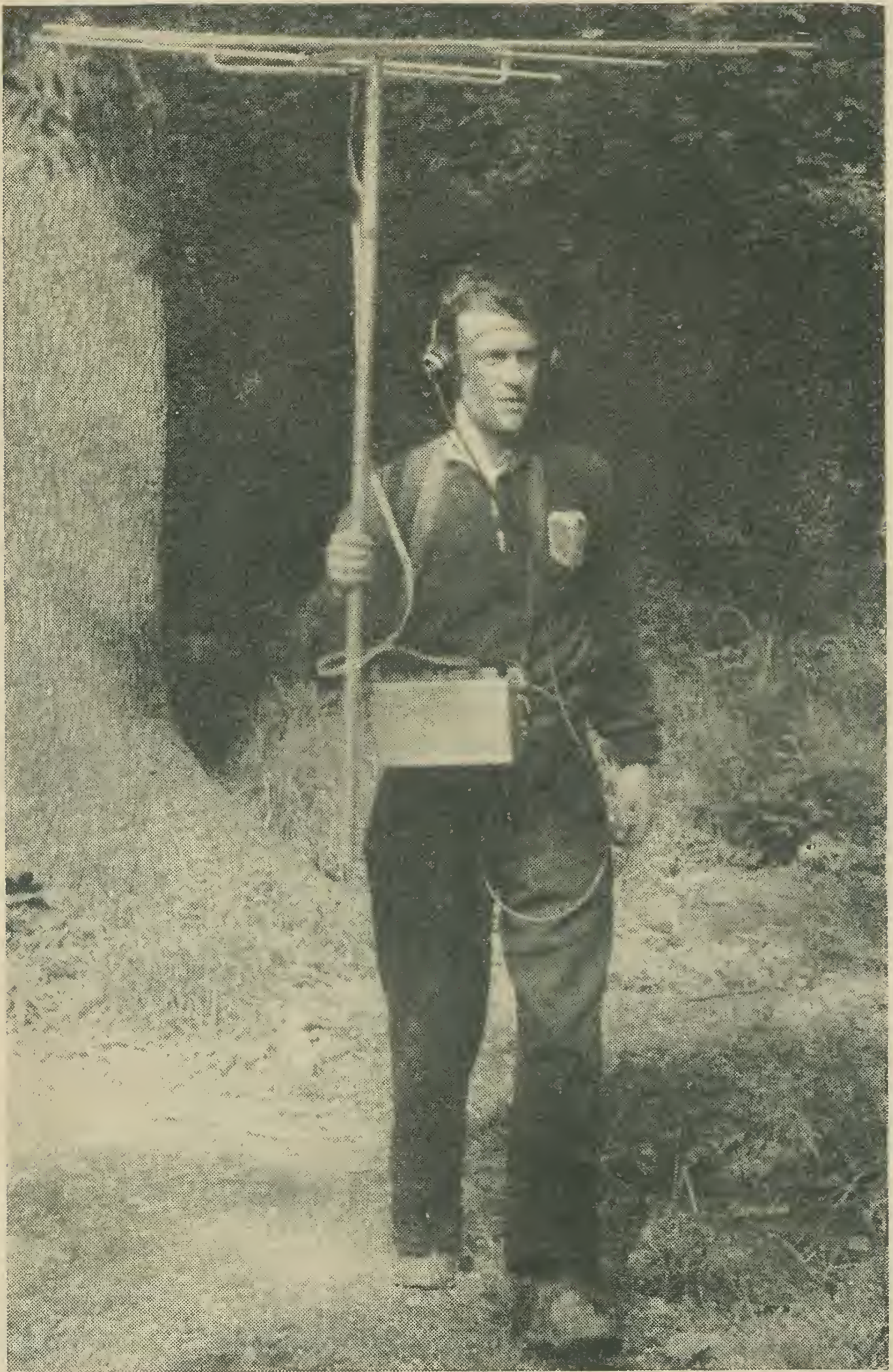
Bild 4 Bei Fuchsjagden auf UKW kommt man nicht umhin, eine solche Antenne mit sich herumzutragen.
